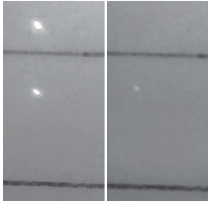
9. ábra. A lézervoltok képe a mérés kezdetekor (balra) és a Brewster-szögnek megfelelő beesési szögnél (jobbra).
